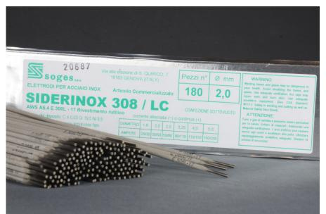
Elettrodo con rivestimento rutilico. Deposito inossidabile tipo 19Cr-10Ni. Salda in tutte le posizioni escluso verticale discendente, fusione dolce e senza spruzzi, deposito estetico, scorificazione facile.
