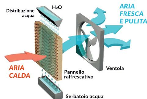
I raffrescatori BRIOTRON raffrescano l'aria grazie ad una speciale tecnologia che sfrutta l' evaporazione dell'acqua per diminuire la temperatura dell'aria.
